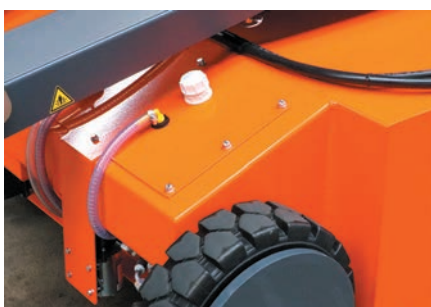
Maschinengehäuse mit integriertem Wassertank inkl. Füllstandsanzeige
